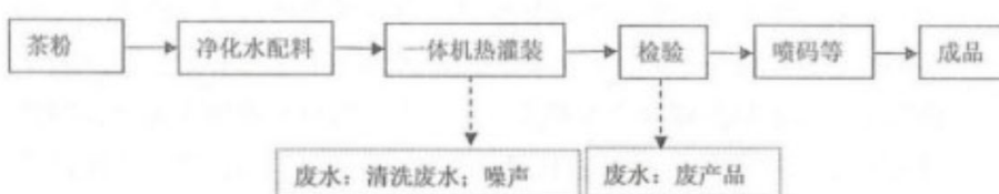
图2.2 项目茶饮料生产工艺及流程图
