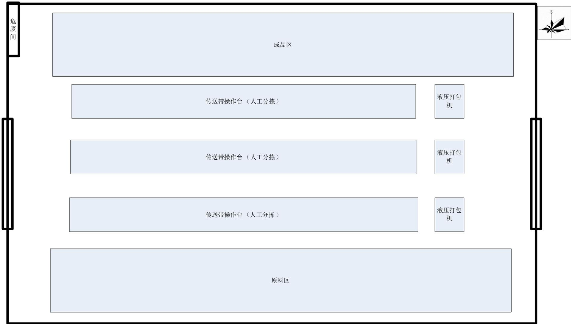
废纸、废塑料分拣厂房平面图 (1: 200)
