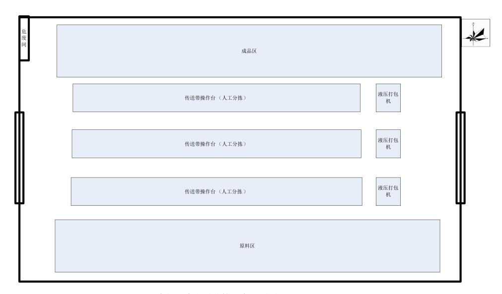
废纸、废塑料分拣厂房平面图(1:200)
