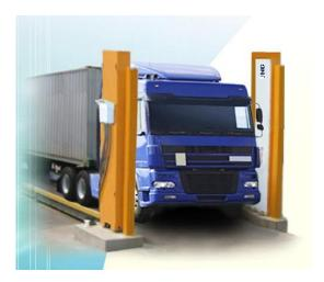
图2-13 钢铁放射性检测门
