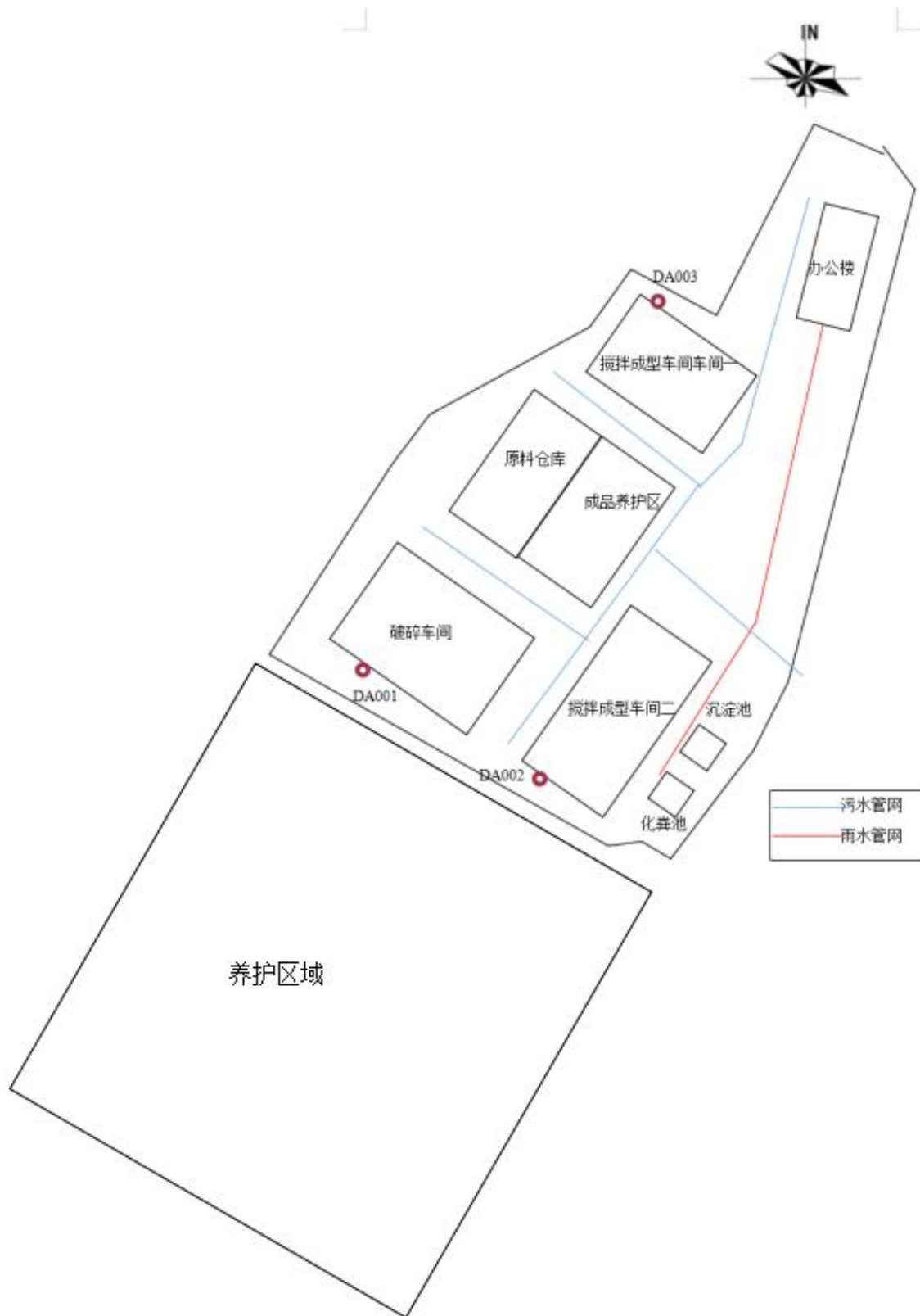
附图4厂区雨污管网图
