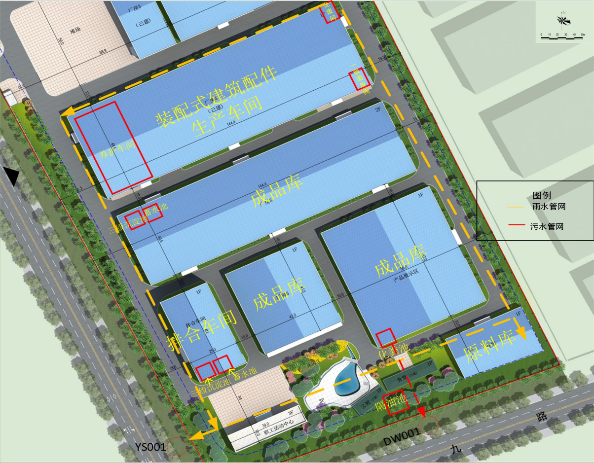
附图6 厂区雨污管网示意图
