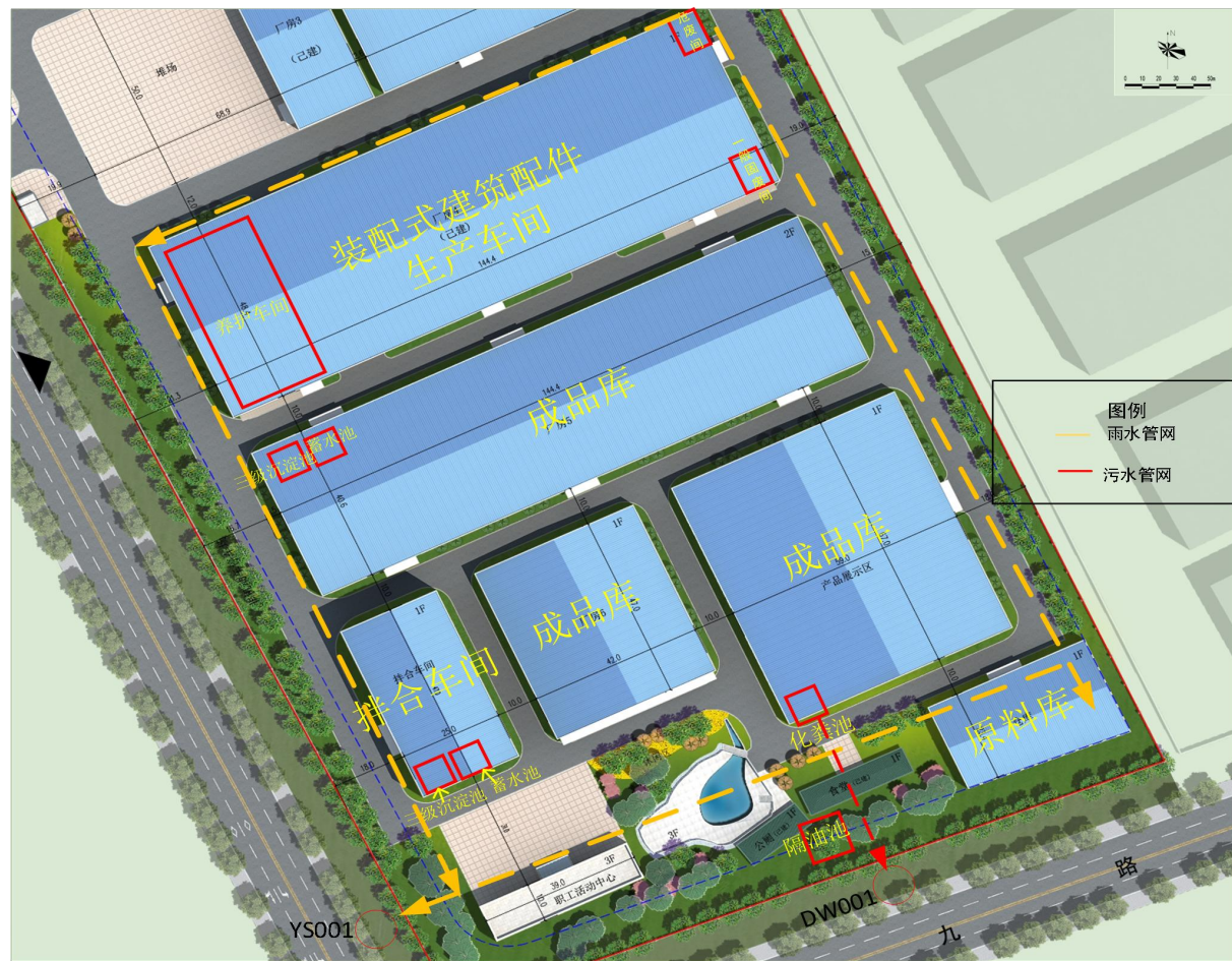
附图 6 厂区雨污管网示意图
