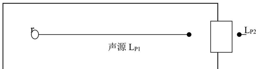
图 4-1 室内声源等效为室外声源图例
