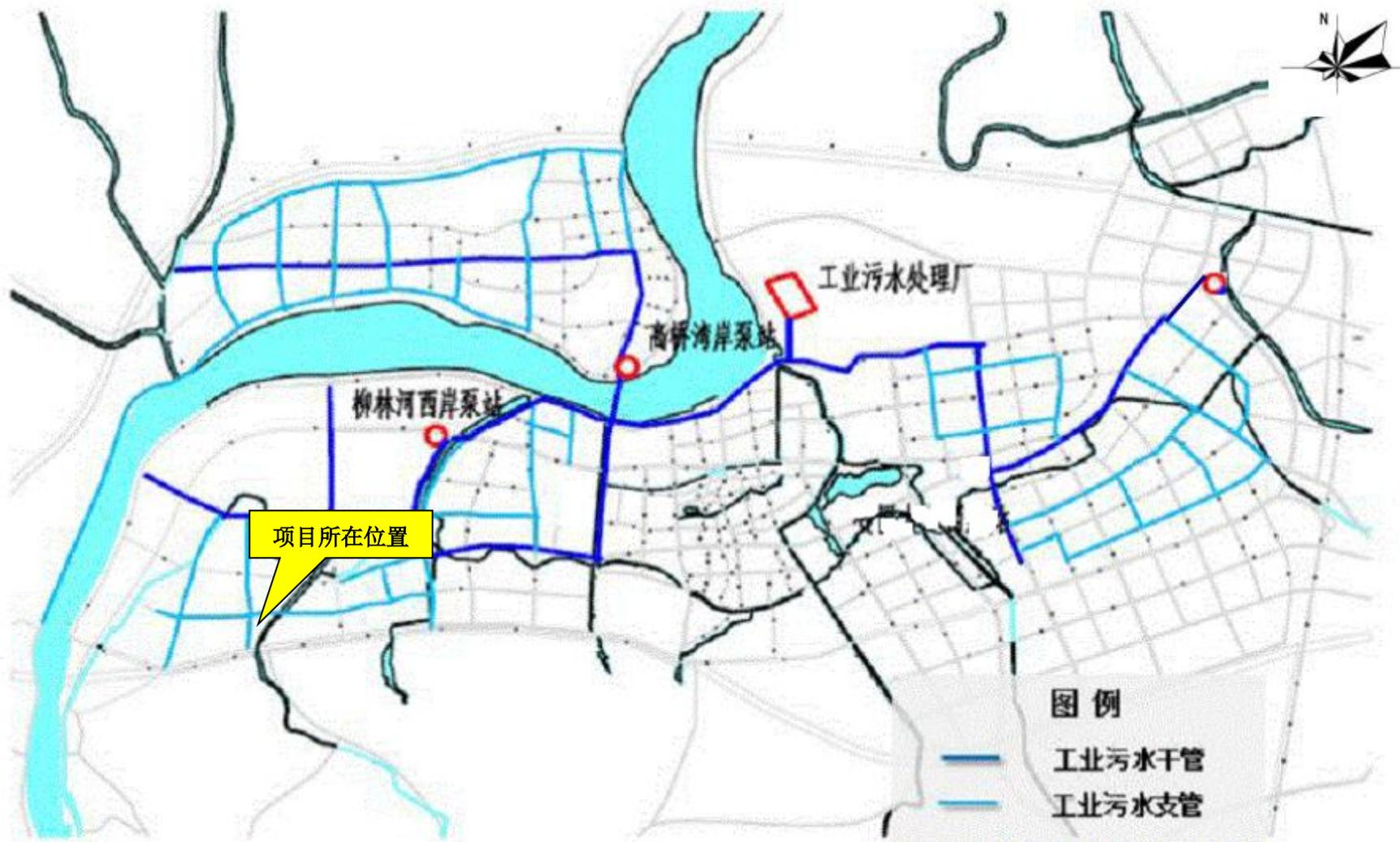
附图 8 霍山经开区工业污水厂污水管网图
