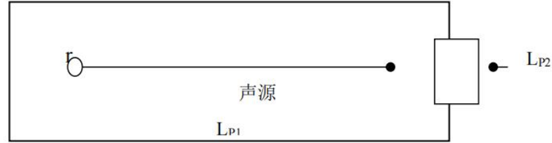
图 4-2 室内声源等效为室外声源图例
