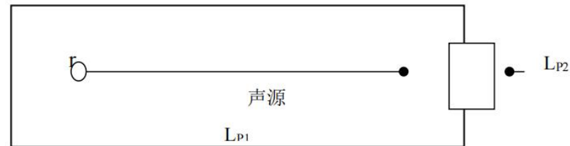
图 4-2 室内声源等效为室外声源图例
