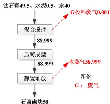
图 2-7 石膏切块生产物料平衡示意图 单位：万吨/年
