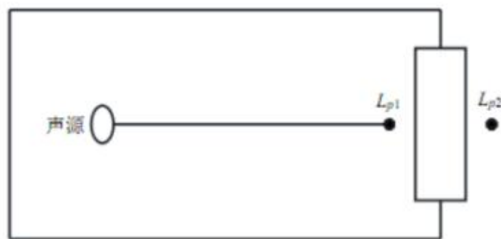
图 4-2 室内声源等效为室外声源图例
