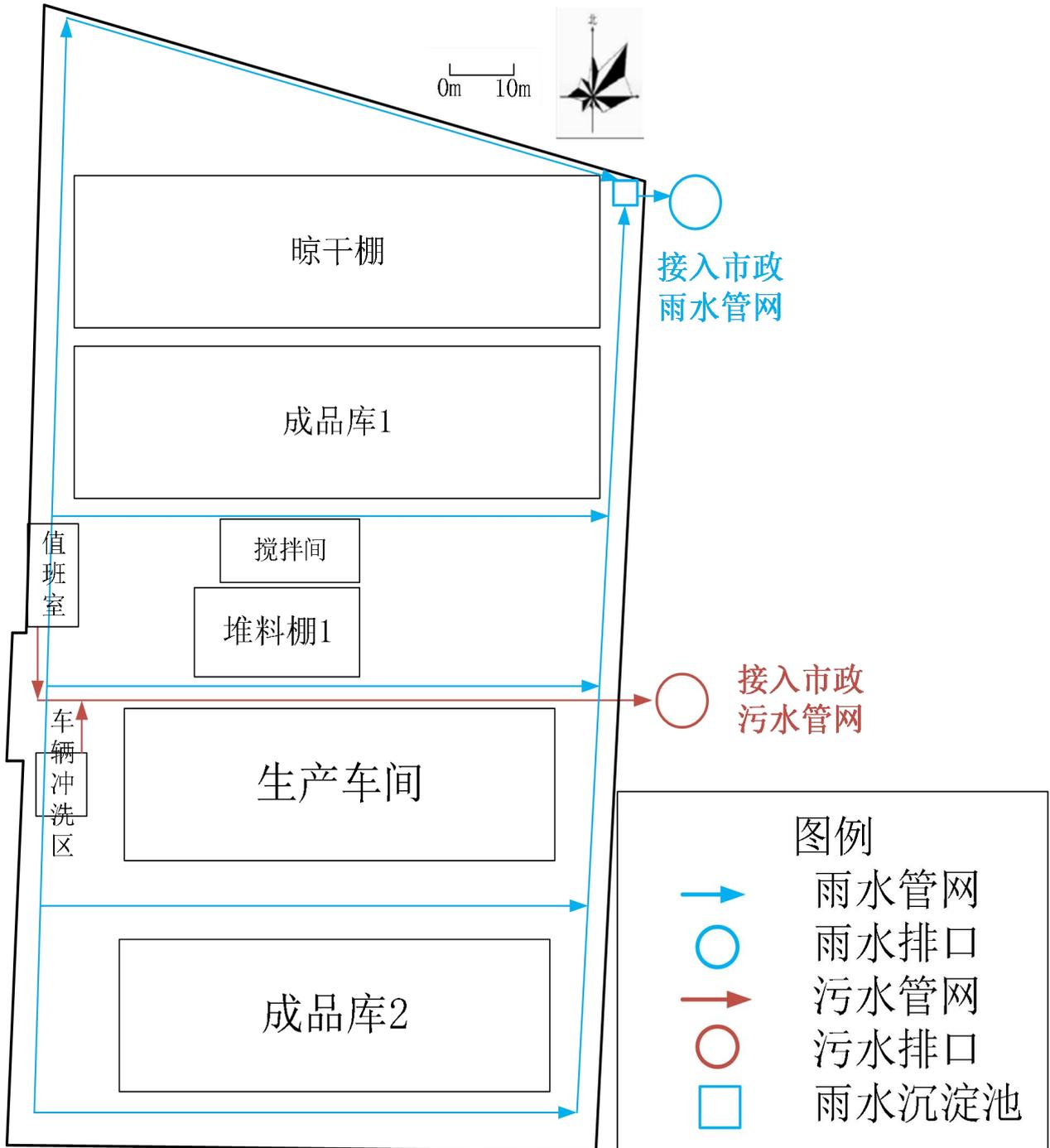
附图9 厂区雨污管网示意图
