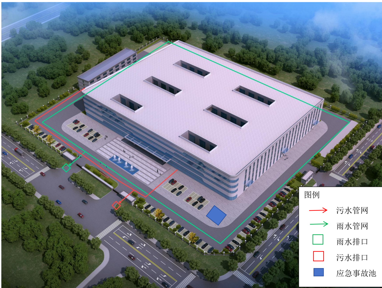
附图 8 厂区雨污管网图
